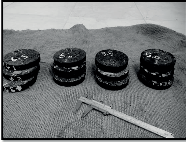
الشكل 3. عينات الخرسانة الاسفلتية المعدة لاختبار الموصلية الحرارية
