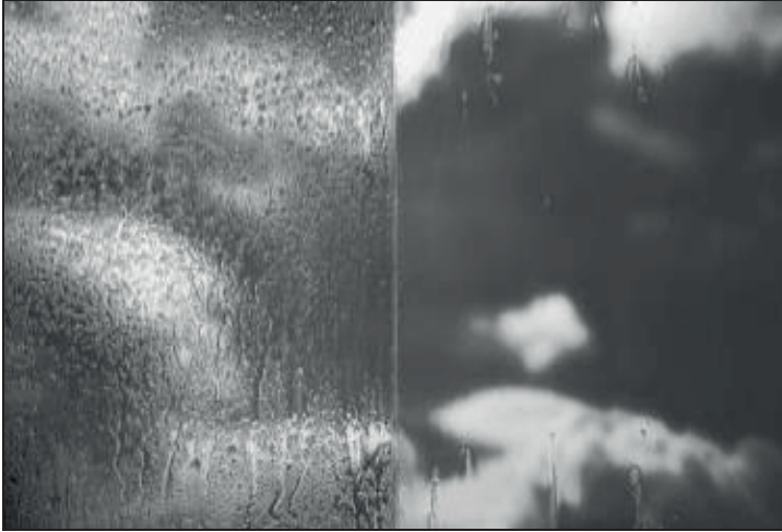
الشكل (4) يوضح الفرق بين زجاج استخدم فيه تقنية النانو وزجاج لم تستخدم فيه تقنية النانو [3]
