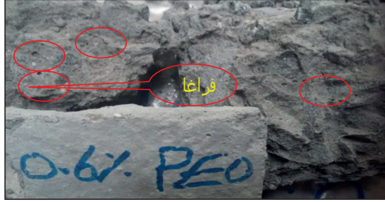
الشكل(9): يوضح بعض الفراغات الصغيرة في الخرسانة الحاوية على UEO s
