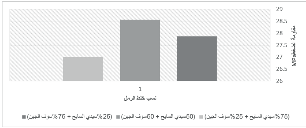
شكل (8) : تأثير خلط رمل سيدي السايح مع رمل سوف الجين على مقاومة ضغط الخرسانة.
