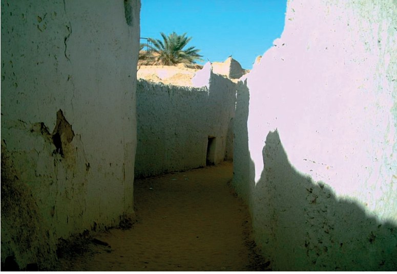
شكل (8): يبين إستخدام أسلوب التعرج في الشوارع كحل بيئي لتلطيف الرياح السائدة مع إستخدام اللون الأبيض في طلاء الحوائط الخارجية لعكس أشعة الشمس وتشتيتها
