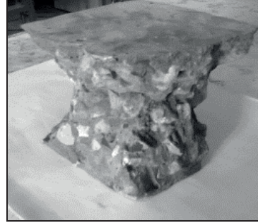
(أ) شكل انهيار العينة القياسية
